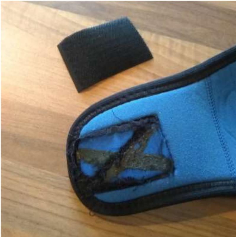
Im nächsten Schritt wurde zuerst auf dem Anzug (per Augenmaß) eine dickere Schicht (dicker, da zum einen ein geringes Aufsaugen durch das Gewebe zu erwarten war, zum anderen sollten die Höhenunterschiede teilweise ausgeglichen werden) und auf dem Klettstreifen ebenfalls eine dünne Schicht Aquasure aufgetragen. Anschließend wurden die bestrichenen Flächen aufeinandergelegt, ausgerichtet
