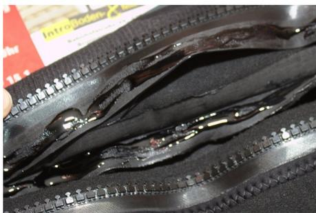
Wenn der Kleber aufgetragen ist, müssen die Leisten gut aufeinandergepresst werden. Die Reißverschlusslippe muss bis in die Nahtkante des Anzuges gedrückt werden. Im Idealfall sollte auf der anderen Seite etwas Kleber austreten. Hiermit wird die Wasserundurchlässigkeit für später sichergestellt.
